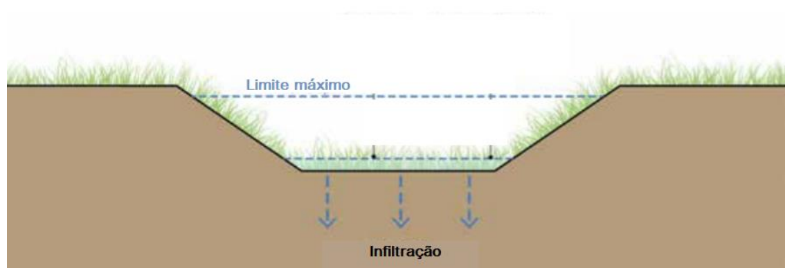
Figura 70 - Esquema típico de uma vala
